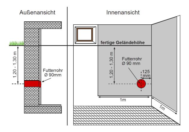
Der grau markierte Bereich muss von Fenstern, Fallrohren und anderen Leitungen freigehalten werden.
