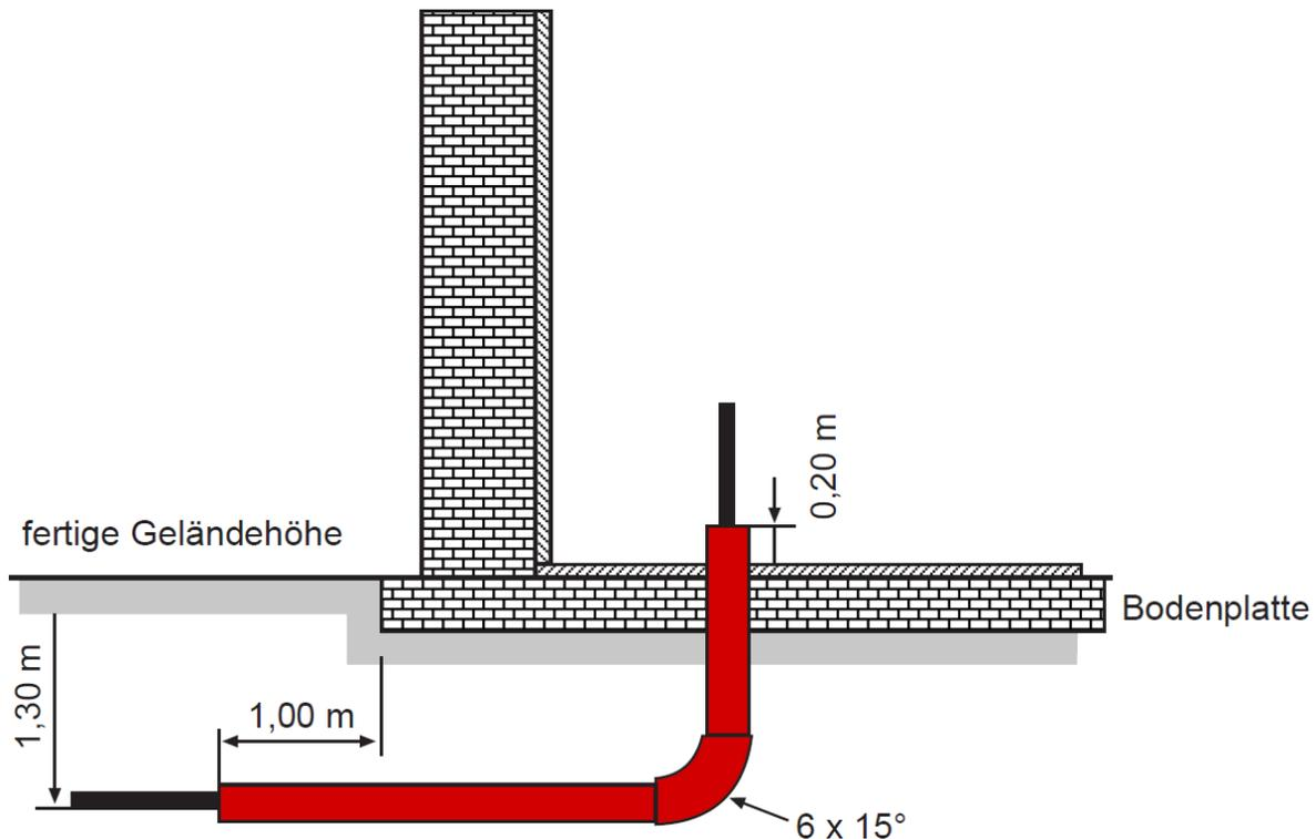
Ist ein Gebäude nicht unterkellert, so müssen für die Durchführung der Wasserleitung durch die Bodenplatte Leerrohre vorgesehen werden. Für den Wasserhausanschluss verwenden Sie bitte ein durchgehendes Leerrohr mit 100 mm Durchmesser (z. B. KG 2000, DN 100), das 1 m vor der Bodenplatte beginnt. Mit 6 Einzelrohrbögen DN 100, 15°, führen Sie das Leerrohr in den Hausanschlussraum.
